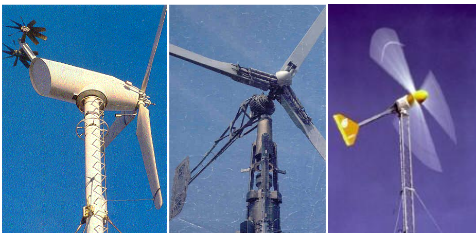
Obr.7: Vľavo turbína Swaneborg s pasívnou reguláciou typu „active stall“, uprostred Jacobs 20kW a vpravo Bergey Excel 10 kW.
